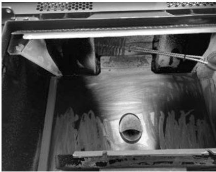
Rys. 28 - Czyszczenie za pomocą środka do czyszczenia rur
