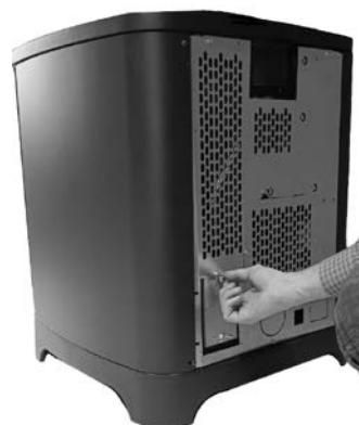
Rys. 23 - Czyszczenie kanału dymowego
