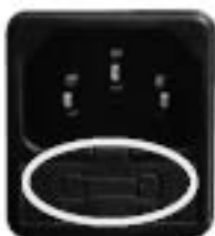
Rys. 31 - Migawka z bezpiecznikami do usunięcia
