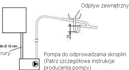
Rysunek 16 Typowa metoda podłączenia rury odprowadzającej skropliny (patrz szczegółowe instrukcje producenta pompy)
