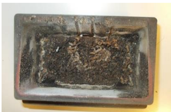
RUSZT KTÓRY WYMAGA CZYSZCZENIA
