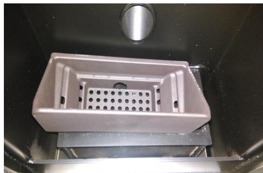
PRZYKŁAD NIEPOPRAWNEGO MONTAŻU
