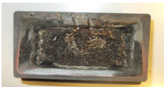
RUSZT KTÓRY WYMAGA CZYSZCZENIA
